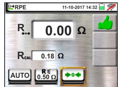
Abb. 7: Kompensation des Widerstandes von Einzelkabeln und Tastkopf
